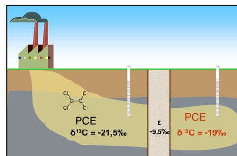
El cálculo del fraccionamiento ( $\epsilon$ ) se realiza en experimentos de laboratorio con el material de la barrera (en este caso hierro cero valente). Una vez conocida la  $\epsilon$ , se puede determinar la eficiencia de la barrera a escala de campo en función del cambio en la composición isotópica del PCE e incluso diferenciarlo de los cambios debidos a biodegradación natural (Audí-Miró et al., 2015).
