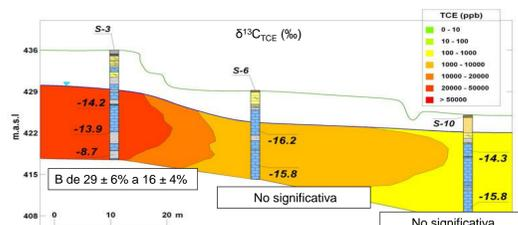
La composición isotópica permite determinar la fracción de contaminante degradado. Un proceso de dilución no modificará la  $\delta$ , en cambio la degradación del contaminante sí. En este caso de estudio se pudo determinar el porcentaje de biodegradación de TCE utilizando valores de fraccionamiento bibliográficos (Palau et al., 2014).
